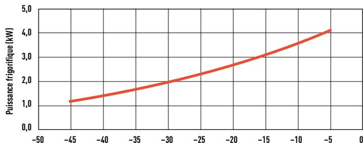
Température ambiante : 32°C, 200V, Compresseur : fréquence de fonctionnement : 65 Hz Réfrigérant : R744, température du gaz d'aspiration : 18°C.
